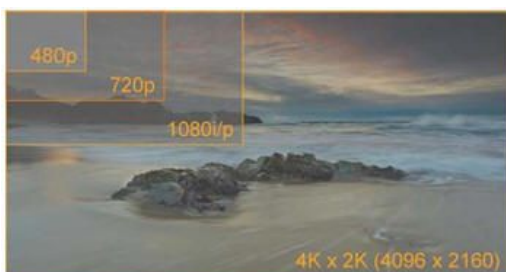
HDMI 設備支持的高清分辨率提高到 4K x 2K, 四倍於目前的 1080p。但頻寬為 4096x 2160@30Hz 與 1080p 的 1920x 1080 @60 Hz x 2 相當, 即相當於 297MHz 像素
